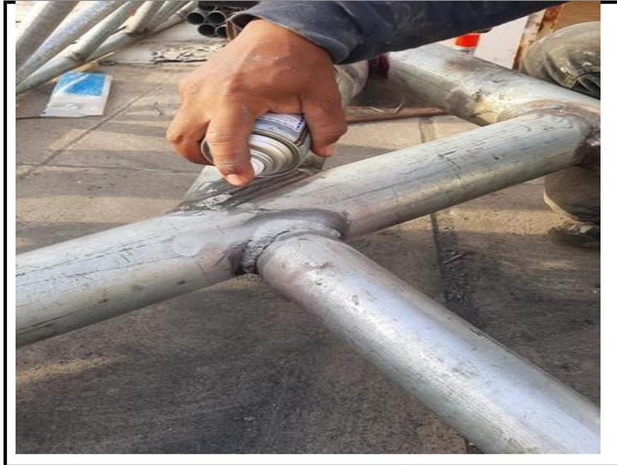
**FOTO N°01.-** SE APRECIA LA APLICACIÓN DE ADITIVO PARA VERIFICAR SI LA SOLDADURA ESTA BIEN TRABAJADA
